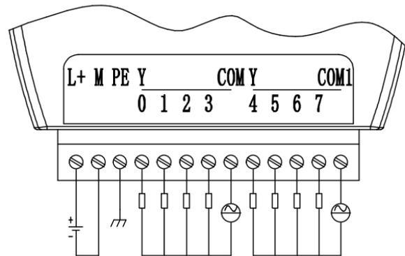
机械继电器负载电压 (30VDC/250VAC)
