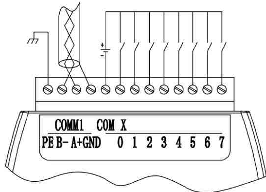
对于漏型输入将“-”连接到“COM”(如图示);对于源型输入将“+”连接到“COM”。
