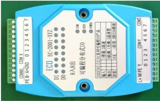
EC-2001 是一款可编程分布式 IO 产品。该产品可以通过 485 接口进行逻辑编程,实现复杂的电气逻辑控制,同时该产品支持 modbus RTU 通信协议,可以作为 modbus 数字量输入输出从站。EC-2001 全部采用工业级芯片, SMT 贴片,回流焊焊接,工作稳定可靠。EC-2001 结构紧凑,节省安装空间。
